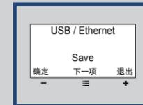
3. 注意: 网络端口与USB端口不可同时开启。一旦启用网络端口, USB端口将会关闭, 反之亦然。
