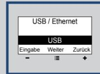
**Schritt 3** ▶ Wählen Sie Ethernet aus, indem Sie FEED -> PAUSE -> FEED betätigen.
